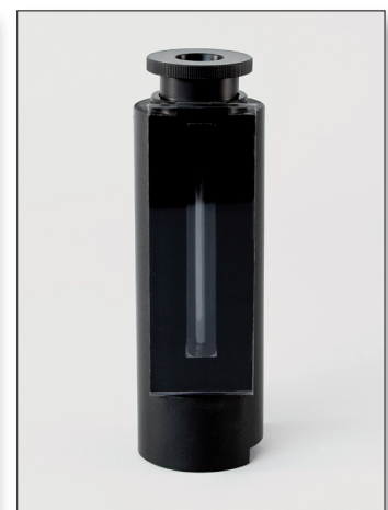
Röhrchenhalter für SW41 oder ähnliche Rotoren
