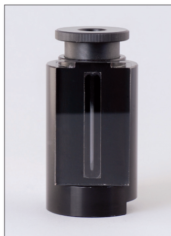
Röhrchenhalter für SW60 oder ähnliche Rotoren
